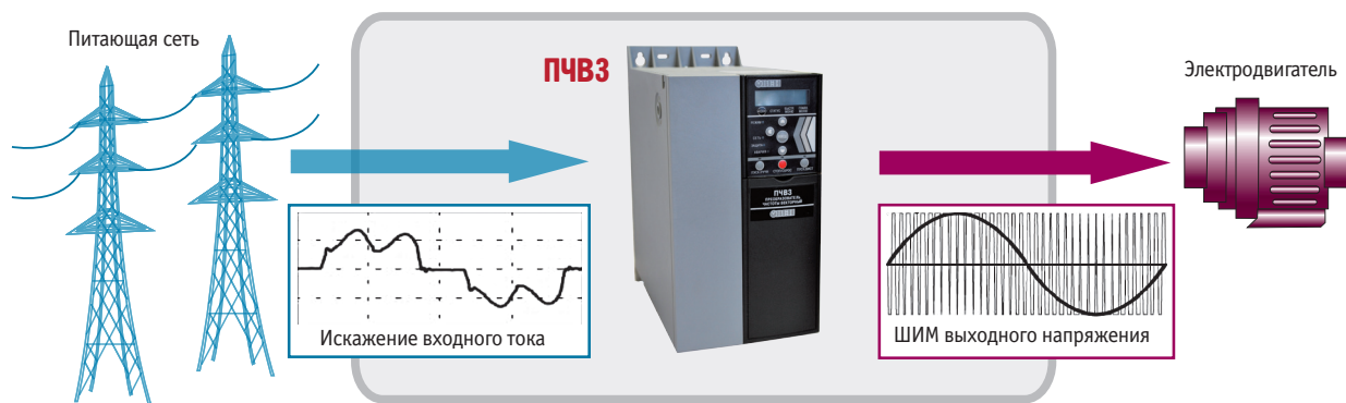
Рис. 1. Входное и выходное напряжение частотного преобразователя
