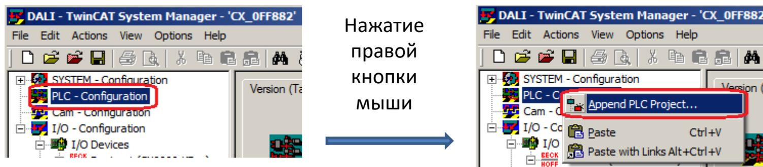
При успешной (без ошибок) компиляции ПЛК-программы в TwinCAT PLC Control в папке с DALI.pro должен был появиться файл описания переменных DALI.tpy. Этот файл добавляется в System Manager.
